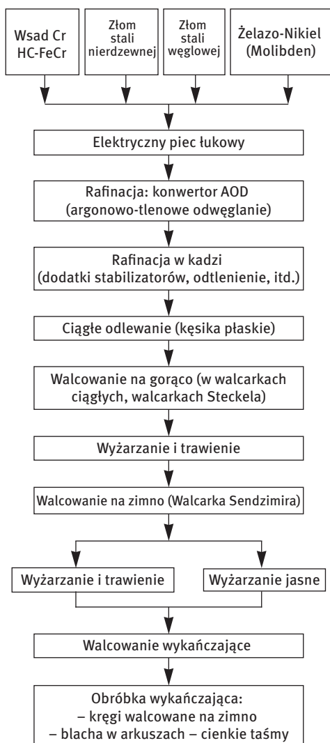
Tablica 1.5.1 - Główne etapy w cyklu wytwarzania zwijanych w kręgi produktów płaskich ze stali nierdzewnych
