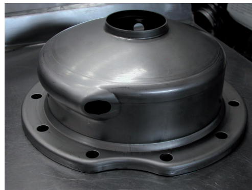
Zdjęcie 16 : Obudowa pompy : Wysoka plastyczność austenitycznych stali nierdzewnych sprawia, że idealnie nadają się do wytwarzania jednoelementowych części przez głębokie tłoczenie i hydroformowanie.
