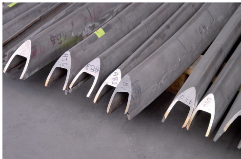
Zdjęcie 8: Kształtowniki wyciskane na gorąco zastosowane w konstrukcji ze stali i szkła "La lentille de la cour de Rome" - Paryż (F)
