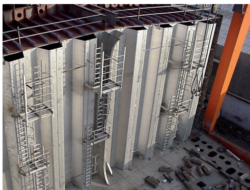
Zdjęcie 17 : Grodzie ze stali nierdzewnej typu duplex stosowane w chemikaliowcach.
