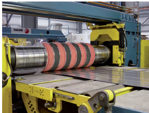
Zdjęcie 3. Linia wzdłużnego cięcia blach
