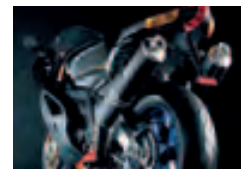
Barwione na czarno stale nierdzewne są szeroko stosowane na wycieraczki i dekoracyjne elementy motocykli. Zdjęcie: Steel Color, Pescarolo Ed Uniti (Włochy)
