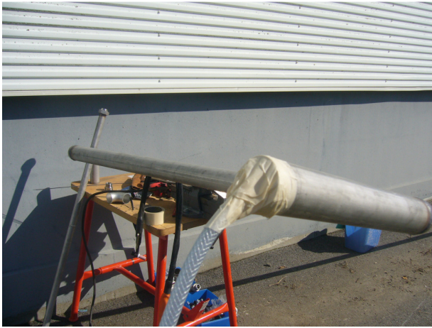
Rys. 6. Przyłącze gazu obojętnego w celu zmniejszenia dopływu tlenu do wnętrza spawanej rury
