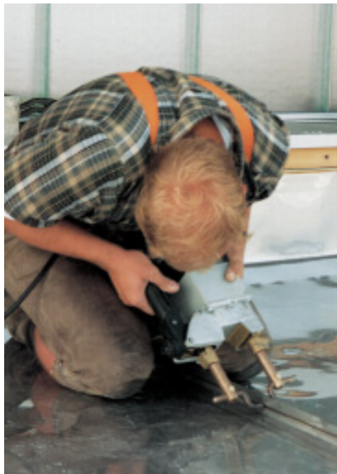
Przenośna zgrzewarka punktowa
