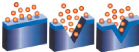
Stal nierdzewna tworzy niewidzialną warstwę ochronną. Warstwa ta samoczynnie odtwarza się, w wypadku uszkodzenia w obecności tlenu z powietrza lub wody.
