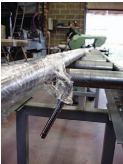
Zmontowane elementy muszą być chronione przed ich zanieczyszczeniem podczas składowania, przenoszenia i transportu
