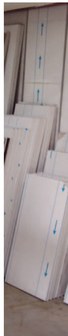
Zazwyczaj na zdzieralnej folii z tworzywa sztucznego zaznaczony jest kierunek walcowania
