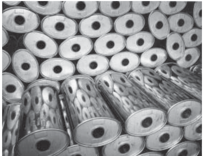
Układy wydechowe - obszar zastosowań ferrytycznych stali odpornych na korozję w budowie samochodów
