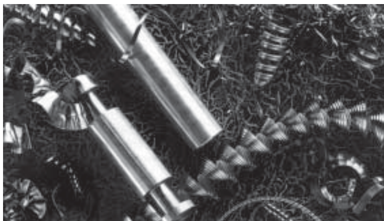
Rys. 7: Przykłady ukształtowania wiórów przy różnych zawartościach siarki
